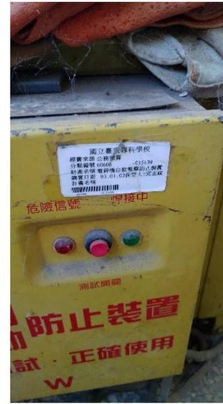
電焊機自動電擊防止裝置
